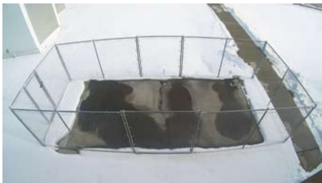
Ученый добавил в состав обыкновенного бетона немного стальной стружки и углеродных частиц (иллюстрация Chris Tuan, Lim Nguyen)
