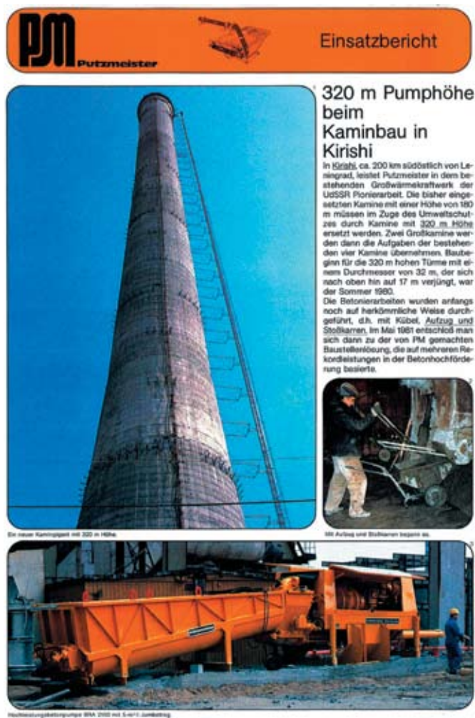
Фото 4. Фотоотчет 1982 года западногерманской фирмы Putzmeister после успешно выполненной работы на трубе высотой 320 м Киришской ГРЭС
