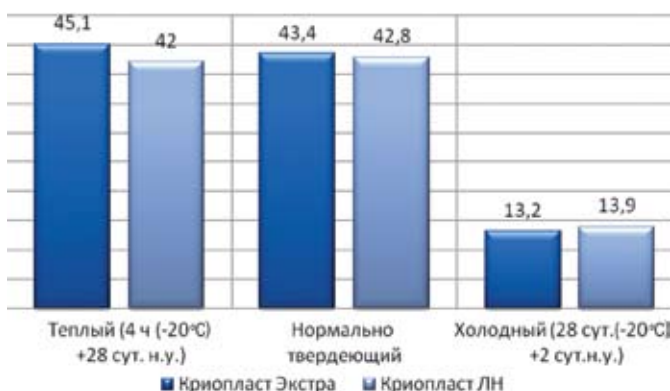
Рис. 4. Прочность образцов бетона с добавками, твердеющего при различных температурных условиях
