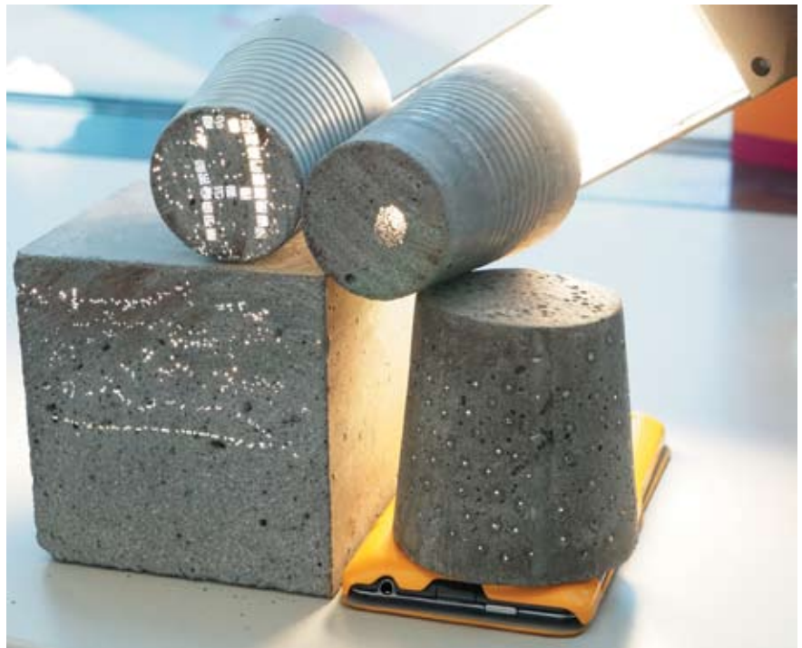
Тестовые образцы светопрозрачного бетона, разработанные лабораторией
