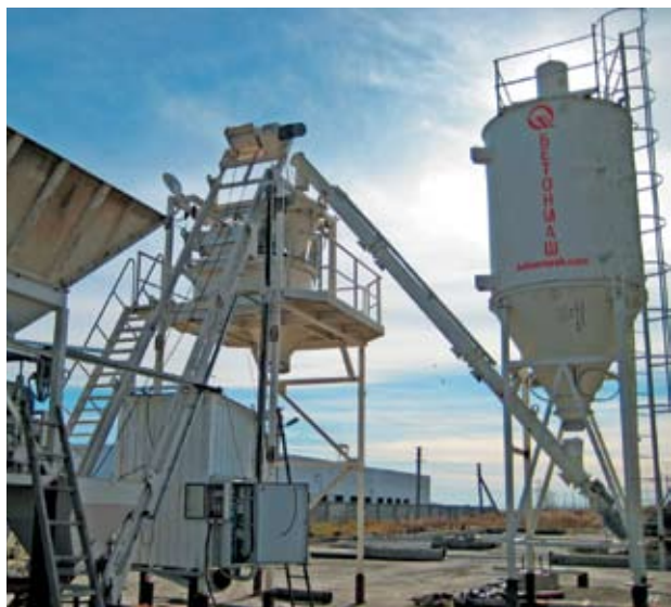
Рис. 1. Мобильная бетоносмесительная установка СБ-241В, производительность 42 куб. м в час
