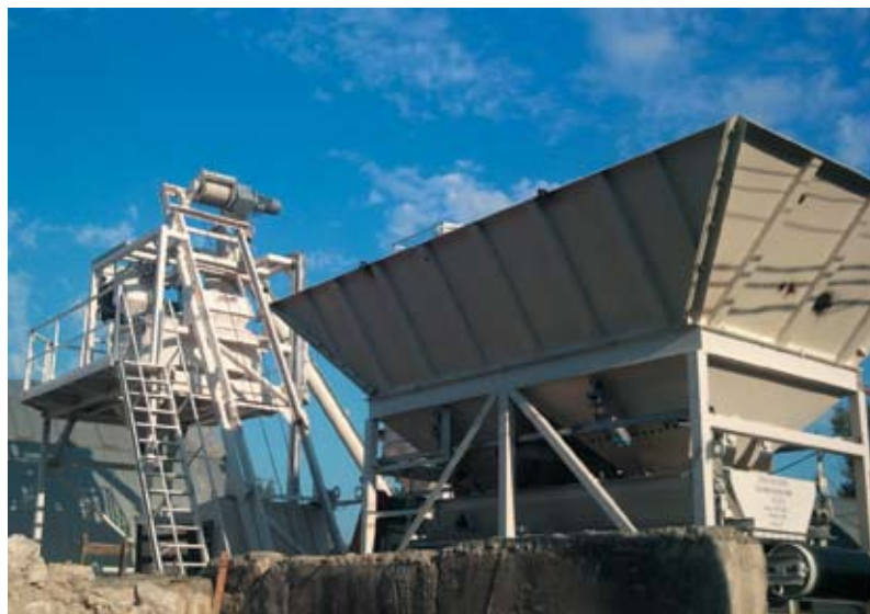
Рис. 1. Мобильная бетоносмесительная установка СБ-241В, производительность 42 куб. м в час
